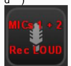
Für Sprachaufnahmen mit zwei Sprecher:Innen können Sie diesen Modus "Mics 1+2 Rec loud" nutzen. Damit werden die Lautsprecher **stumm** geschaltet.
